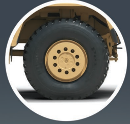
Patlar gider lastikler sistemi (Runflat teknolojisi) ile dış lastik patlarsa bile iç lastik ile olay yerinden uzaklaşabilme...
